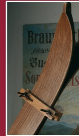
Um die Skier über den Sommer auf Spannung zu halten, wurden Spanner mit Flügelschrauben (oben) angebracht. Für die nötige Spannung sorgte ein Klötzchen zwischen den Bindungen (unten).
