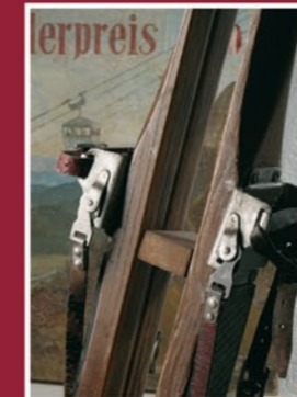
Um die Skier über den Sommer auf Spannung zu halten, wurden Spanner mit Flügelschrauben (oben) angebracht. Für die nötige Spannung sorgte ein Klötzchen zwischen den Bindungen (unten).
